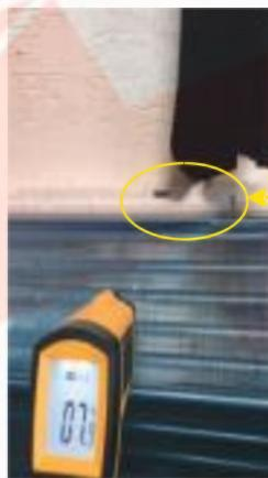
Ejemplo de diferencia de temperatura en secciones del serpentín, aquí vemos que la parte superior mide 7°C y la parte inferior 22 °C
