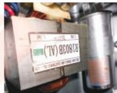
Filtra el voltaje de corriente directa pulsante dejando un bus de CD fijo con poca variación. En algunos modelos cuenta con Reactor(mH) y Capacitor(Mfd) externos y si alguno pierde sus valores de fabrica esta etapa provoca calentamiento en la tarjeta.
