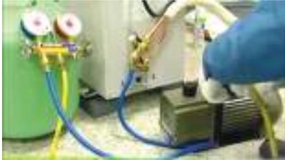
**1** Abrir las válvulas de servicio en el condensador, comenzando con la descarga y seguimos con la succión.
