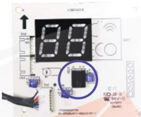
2. Para identificar la terminal negativa, mida continuidad entre cada una de las terminales del sensor y el negativo de la tarjeta electrónica.
