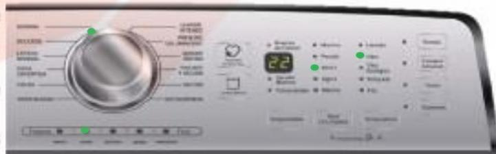
**3** **Pruebas de Secado.**- ingresa al modo de “Pruebas en Seco” y presiona la tecla **K7**: se encenderan los indicadores de “Normal” y “Secado”:
