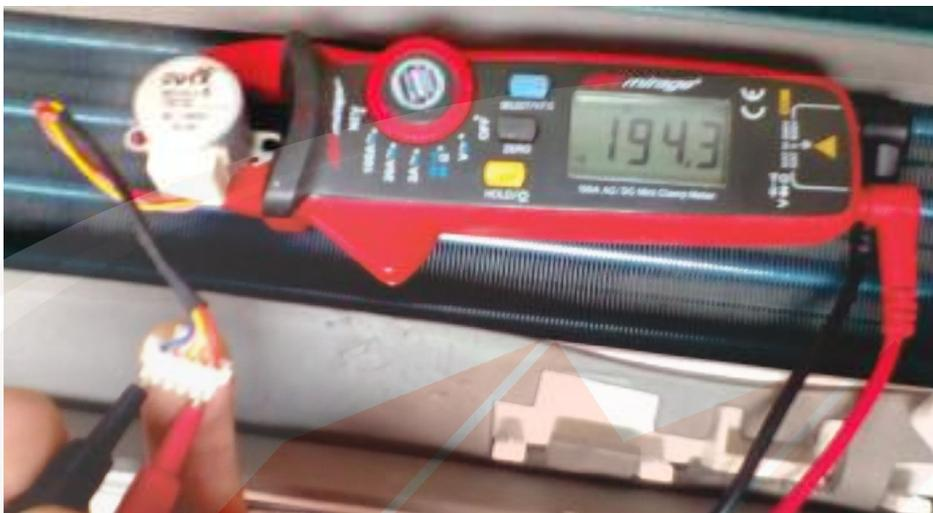
4. Si al realizar las mediciones anteriores alguna de los valores obtenidos se encuentra fuera de rango, se concluye que alguna de las bobinas esta en circuito abierto o corto circuito. Reemplace el motor.
