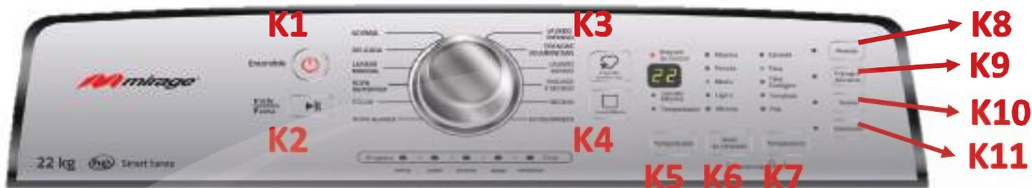
**1** Para entrada al modo de “Pruebas en Seco”, debes presionar **K8** y **K9** y sin soltarlos presionar **K1**, al encenderse los indicadores de ciclo y antes de emitir seis alarmas deberas ingresar la tecla de programación a probar.
