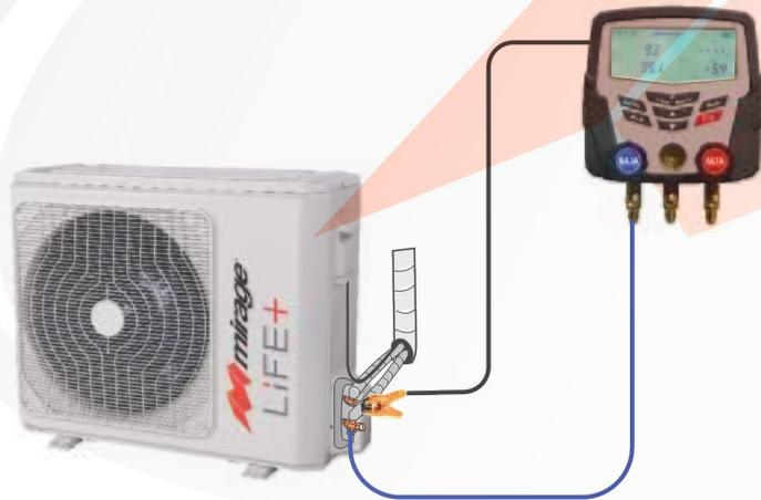
En los equipos de expansión directa tipo "minisplit", el recalentamiento se obtiene tomando la temperatura y la presión del retorno, ejemplo:
