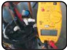
Antes de instalar un compresor debe identificarse plenamente cada una de las terminales.
